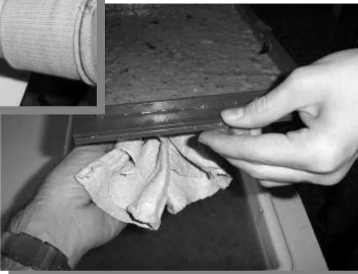
Anschließend wird mit einem Wischtuch, durch abwischen der Unterseite des Siebs, das Wasser aus dem Papier gezogen. (Mindestens 3x)
